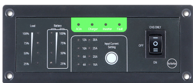
Panou control modul afișare la distanță
